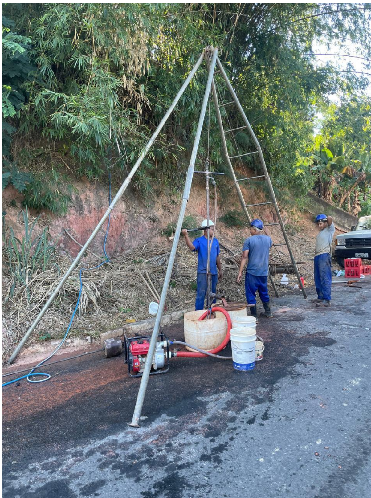
Figura 6 – Execução da sondagem SPT
